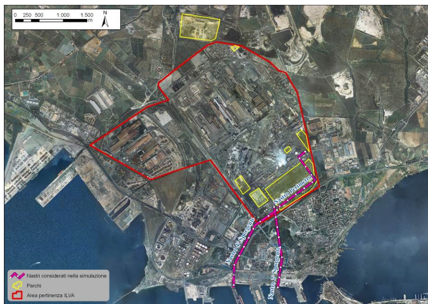
Fig.17 Localizzazione delle sorgenti areali (parchi e movimentazione) e lineari (nastri) presenti all'interno dello stabilimento ILVA di Taranto
